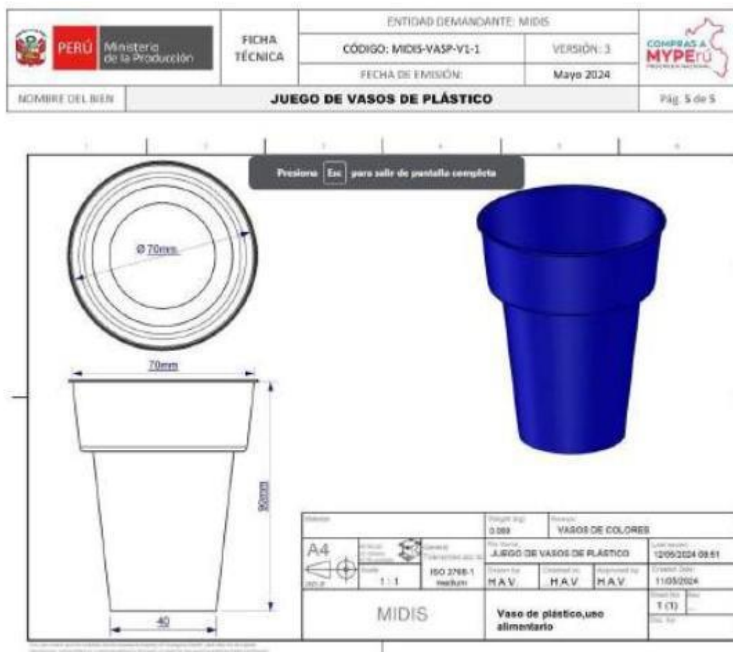
Figura 1. Esquema dimensional del vaso de plástico
